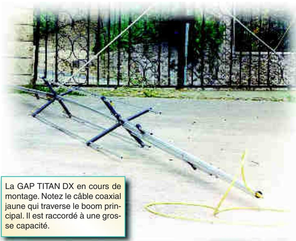
La GAP TITAN DX en cours de montage. Notez le câble coaxial jaune qui traverse le boom principal. Il est raccordé à une grosse capacité.
