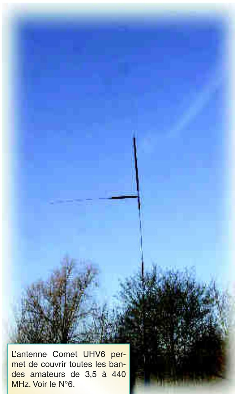
L'antenne Comet UHV6 permet de couvrir toutes les bandes amateurs de 3,5 à 440 MHz. Voir le N°6.
