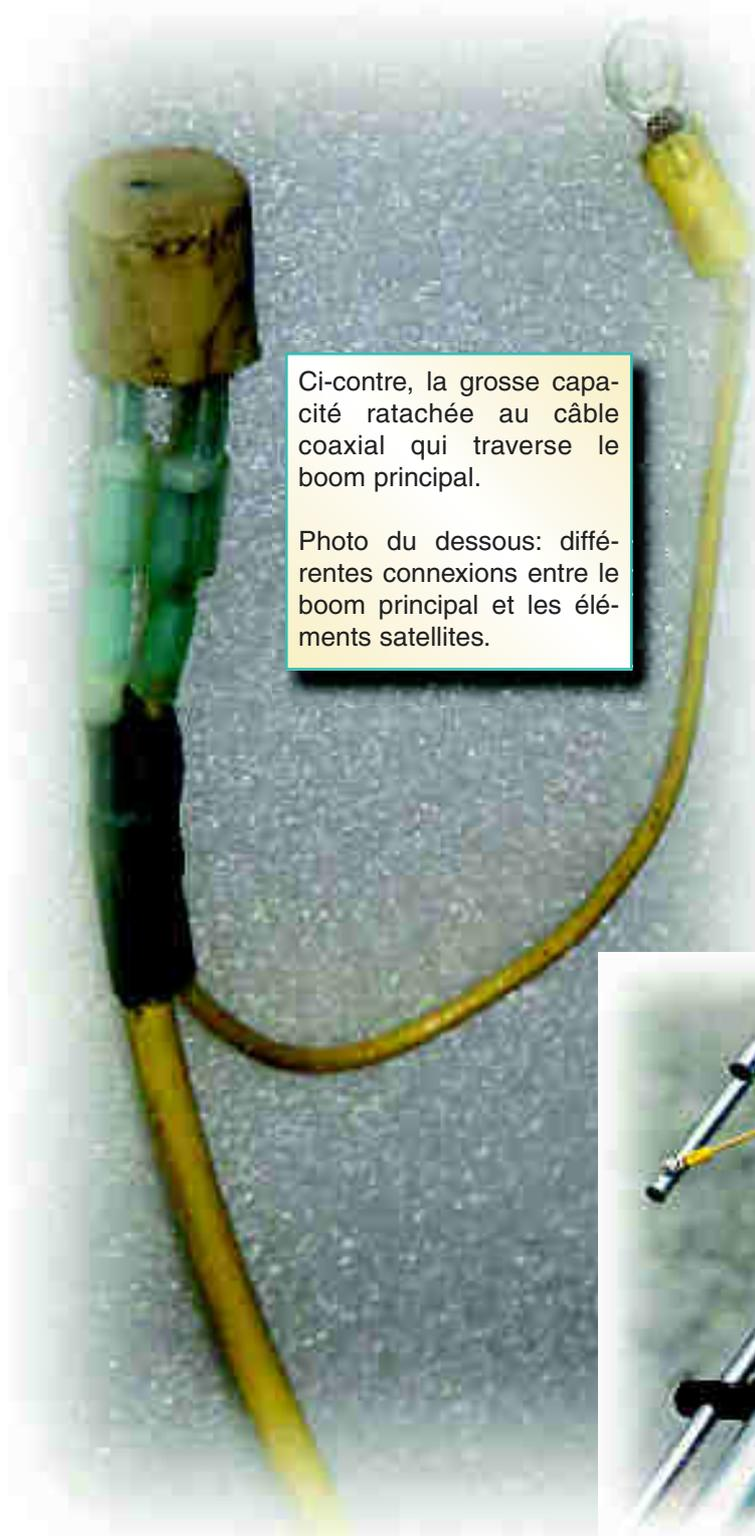
Ci-contre, la grosse capacité rattachée au câble coaxial qui traverse le boom principal.
