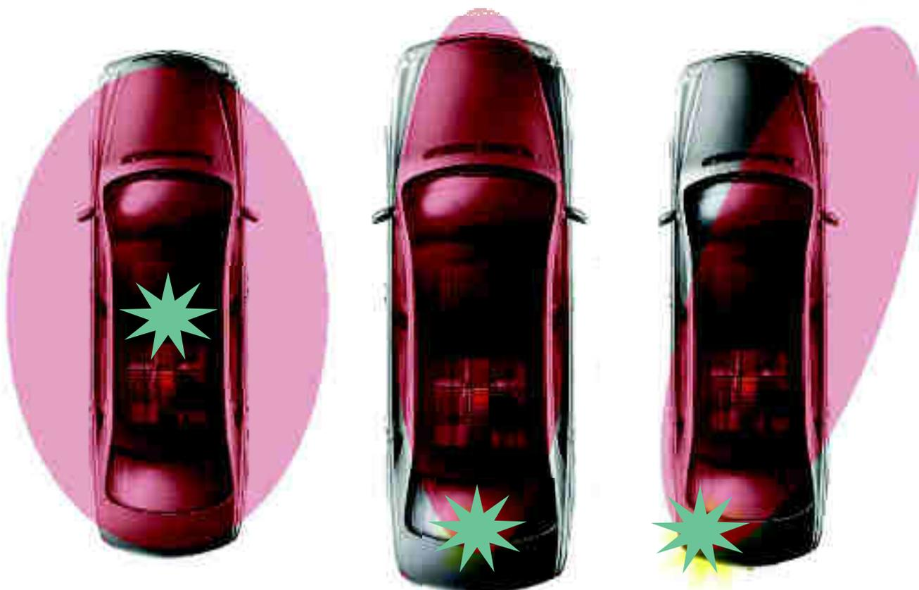
En fonction de l'emplacement de votre antenne sur la carrosserie la directivité change. L'antenne est ici représentée par l'étoile verte-bleue. Voir aussi dans les actualités de ce magazine pour lire quelques renseignements sur ce qui est appelé «l'angle de tir» ou angle d'attaque des antennes. En fonction de leurs caractéristiques électriques les antennes s'adaptent plus ou moins aux conditions de trafic.
