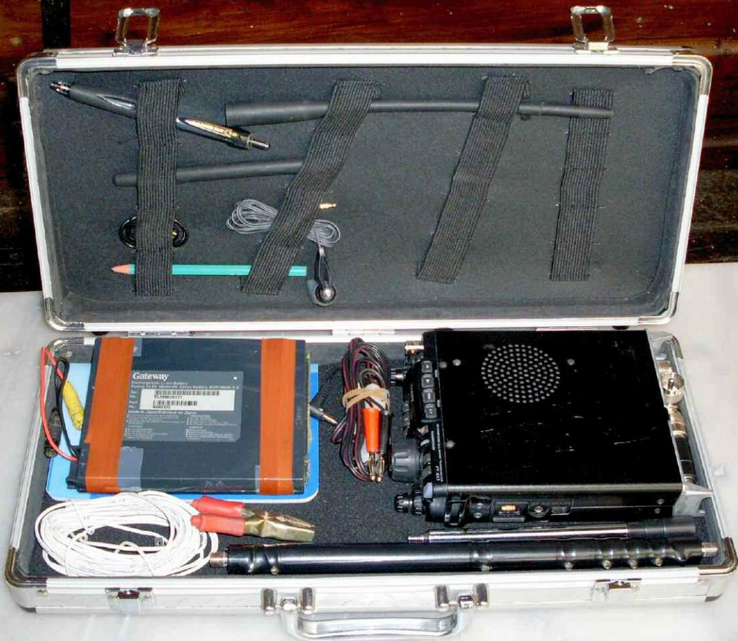
Dans mon cas j'ai ouvert le pack et déconnecté l'électronique qui gère la charge de la batterie. Celle-ci charge séparément les éléments et les contrôle tout au long du cycle. Ce qui en fait une sécurité redoutable et nécessaire. J'ai donc démonté tout cela parce que je suis forcé de modifier la fonction de charge. Mon FT 817 a une plage de fonctionnement de 8 à 16V et donc la tension de ma batterie est bien dans cette plage ce qui me permettra d'avoir une autonomie importante.
