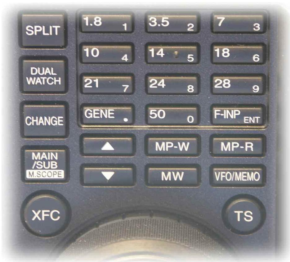
Gros plan sur le clavier digital. Ses touches sont un peu sèches pour assurer un maniement rapide et sans faute. Il permet de rentrer les fréquences directement. La touche GENE passe le récepteur en couverture générale des ondes courtes. Celle marquée TS permet de modifier les pas interférences. On met en route d'ici la double réception avec le DUAL WATCH ainsi que le SPLIT pour les concours. Une chose dont on a pas parlé dans le texte concerne les mémoires, le 7600 en est bardé bien entendu.
