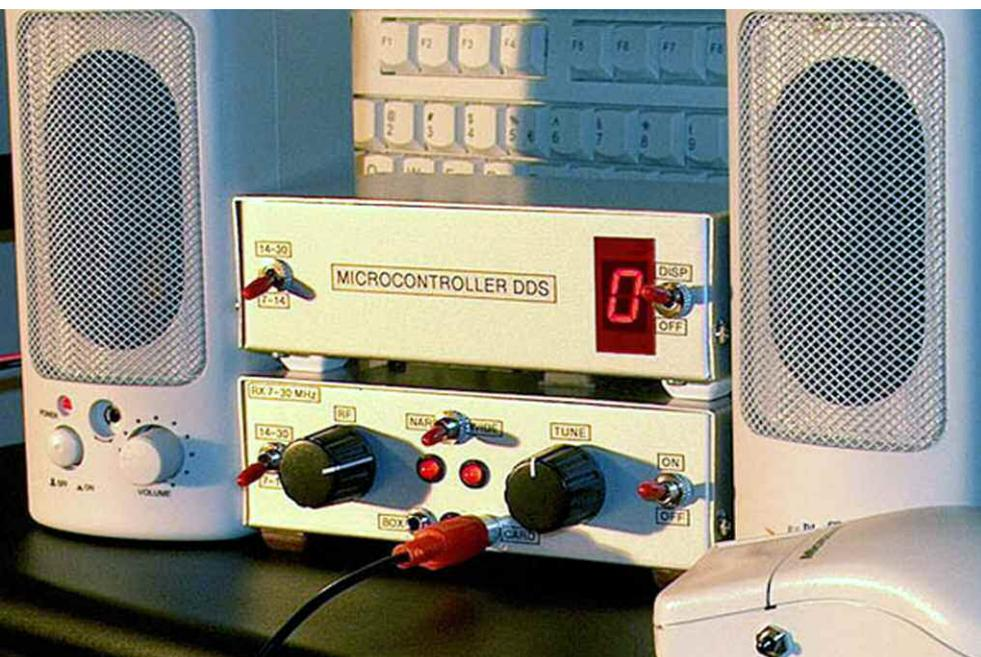
*J'ai lu dans "QRP magazine" de septembre 2002 l'article de Ton, PA0KLT sur un système "QRP tuning". Le système fonctionne avec un DDS faite autour d'un microcontrôleur. L'avantage est que vous n'avez pas besoin d'acheter une puce DDS difficile à obtenir et à souder avec son empreinte CMS. Un microcontrôleur simple et bon marché peut faire le travail de la même façon. Il contrôle même les*
