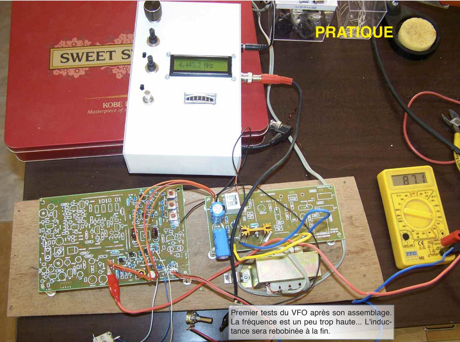
Premiers tests du VFO après son assemblage. La fréquence est un peu trop haute... L'inductance sera rebobinée à la fin.
