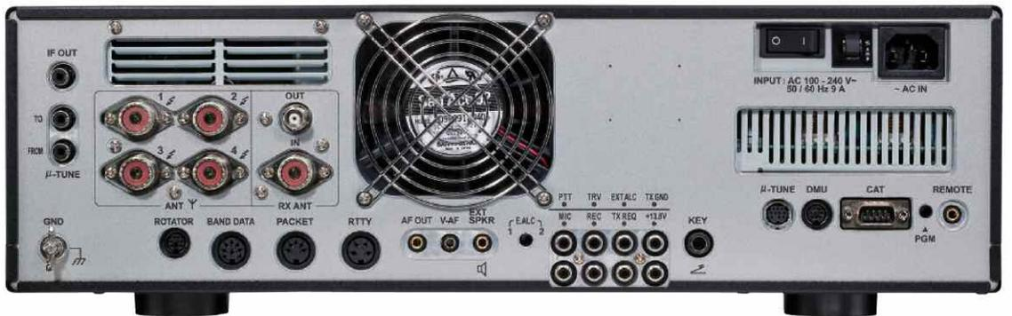
Il suffit donc de brancher la source d'alimentation de 13,8 volts et c'est parti. Comme évoqué au début, ces FT DX 5000 permettent d'obtenir une puissance maximale de 200 watts PEP en régime de linéarité "normale".
