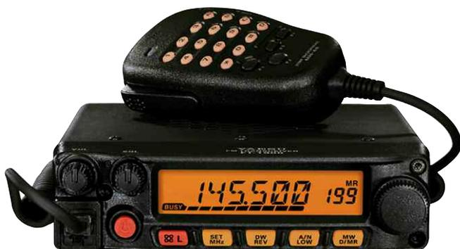
Il couvre en émission la bande amateur de 144 à 146 MHz mais peut permettre de recevoir le spectre radio entre 136 à 174 MHz.
