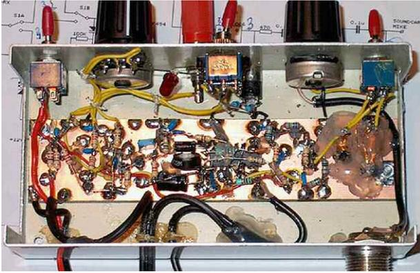
Il y a un interrupteur supplémentaire pour désactiver l'affichage de fréquence pour obtenir des signaux plus propres en sortie RF du VCO.
